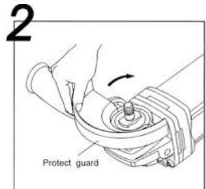
Затем проверните кожух на 180° по часовой стрелке (Рис.3) и затяните винт защитного кожуха
