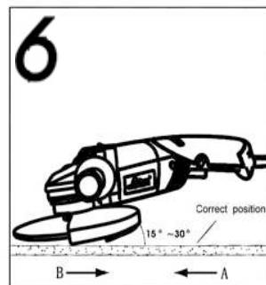
Г) Не передвигайте инструмент по направлению В, если используете новый диск, т.к. обрабатываемая поверхность может быть изрезана острой кромкой диска. Только после того, как кромки диска сгладятся, можно передвигать машину в двух направлениях: А и В.
