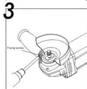
Защитный кожух должен поддаваться повороту только после того, как будет ослаблен винт защитного кожуха! В противном случае электроинструмент нельзя больше использовать и он должен быть передан сервисной службе.
