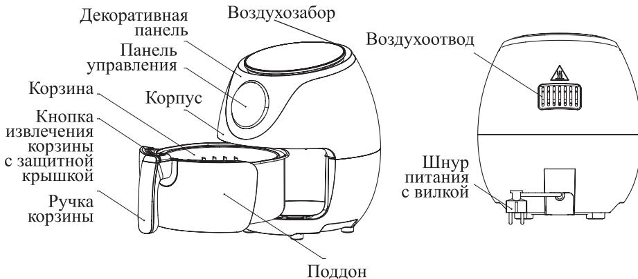
Принцип работы аэрогриля основан на конвекции воздушных потоков от нагревателя внутри рабочей емкости. Вентилятор, расположенный в верхней части аэрогриля, приводит в движение воздушные массы, нагретые до высокой температуры ТЭНом (Трубчатым электронагревателем). Горячий воздух циркулирует внутри рабочей емкости аэрогриля и нагревает продукты до нужной кондиции.
